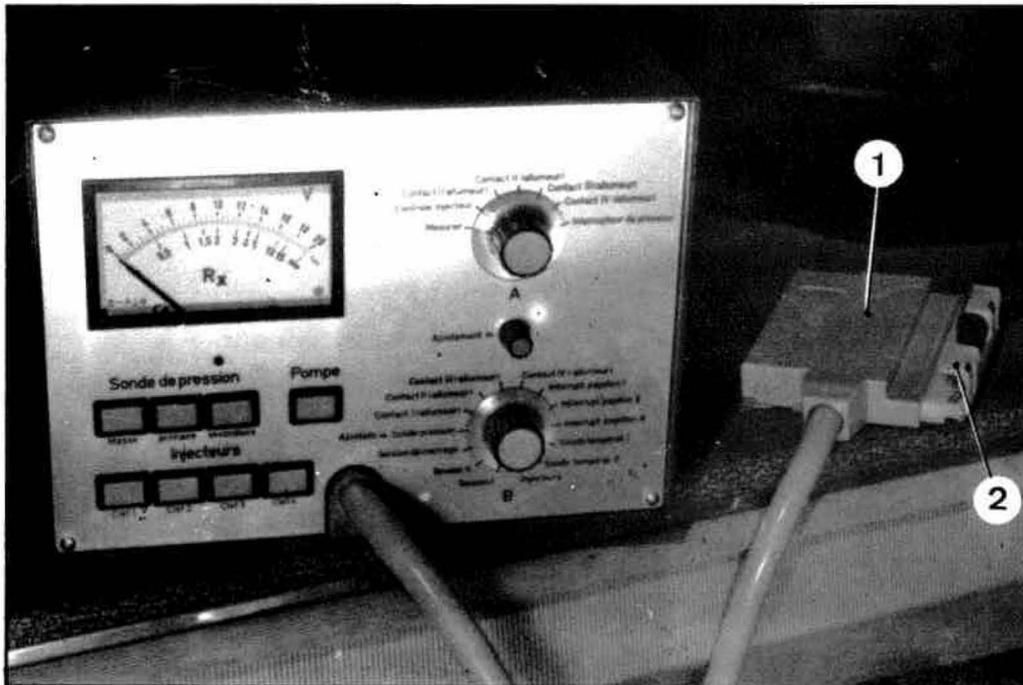
Enficher le connecteur (1) du contrôleur BOSCH EFAW 228 - S 11 et le connecteur (2) du calculateur électronique.
