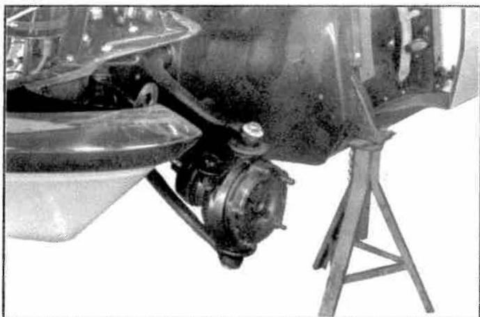
16. Faire appuyer par un aide sur la pédale de frein (pour centrer l'étrier) et serrer les vis de fixation de l'étrier de frein hydraulique.
