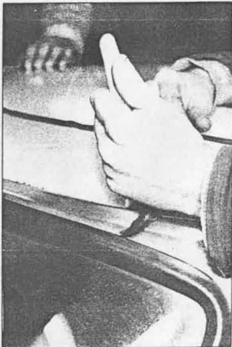
Présenter les cordons de mastic d'étanchéité avant dans la gouttière.
