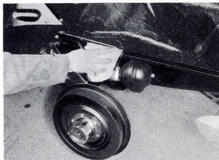
Essuyer convenablement les pièces pour éviter d'introduire de l'eau dans le cylindre ou le bloc pneumatique au moment de la dépose de ce dernier (photo n° 2 et 2 bis).
